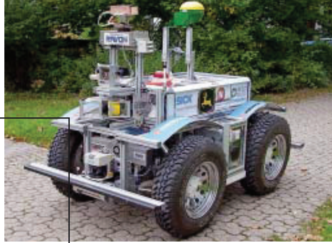
Anhand des autonomen Elektrofahrzeugs Ravon (rechts das Simulationsmodell) wurde das Verhalten von Batterien für Elektrofahrzeuge getestet
